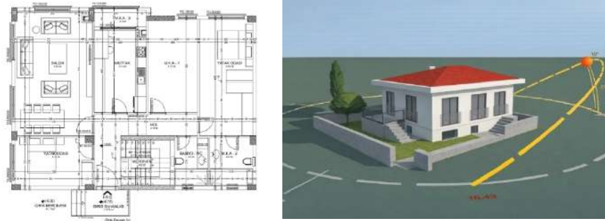
Şekil 1. Referans binanın üç boyutlu enerji modelinin oluşturulması
