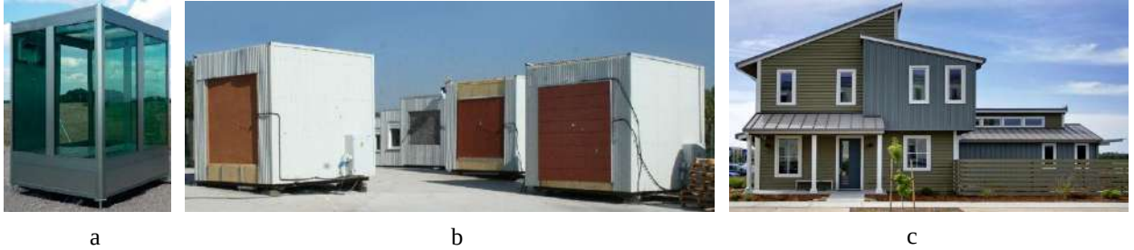
Şekil 2. a) tek test hücresi [23], b) çoklu test hücreleri [15], c) farklı sayıda mekanları barındıran test binası [9]
