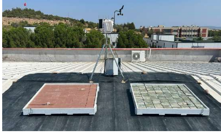
Şekil 4. Deneysel çatı sistemi (endüstriyel-solda ve yansıtıcı kaplamalı-sağda kiremitler olmak üzere).
