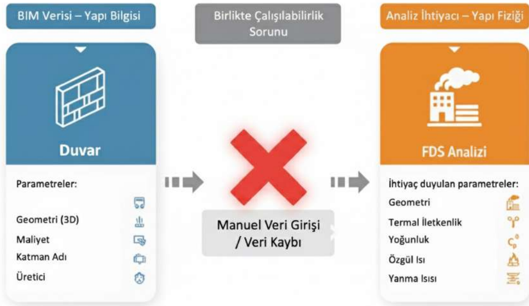
Şekil 2. Yapı bilgisi ve yapı fiziki arasındaki semantik veri kopukluğu
